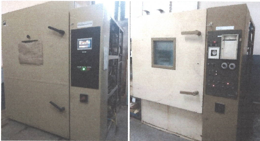
Рисунок 3 – Кліматичні камери для проведення циклічних кліматичних впливів
