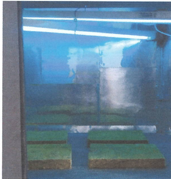
Рисунок 7 – Загальний вигляд дослідних зразків теплоізоляційного матеріалу марки «ТЕХНОБЛОК СТАНДАРТ» під час опромінення
