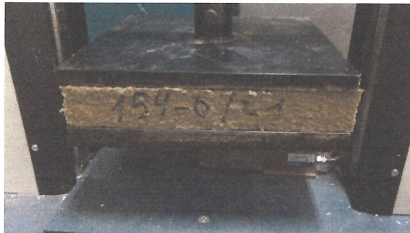
Рисунок 5 – Проведення випробування та типова експериментальна залежність міцності на стиск при 10% деформації зразків теплоізоляційного матеріалу марки «ТЕХНОБЛОК СТАНДАРТ»
